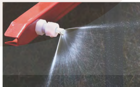
ACCIONAMIENTO CONTROL SELECTIVO BOQUILLA DERECHA
