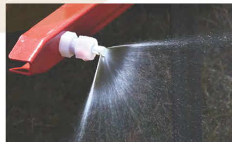
ACCIONAMIENTO CONTROL SELECTIVO BOQUILLA DERECHA
